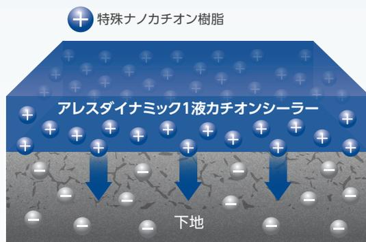
超微粒子の特殊ナノカチオン樹脂が高い浸透力と毛細管現象で新生瓦など下地層に浸透
